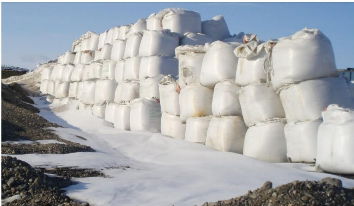
Хранить сухие смеси TORCRET QUICK BETON следует в оригинальной закрытой заводской упаковке вдали от прямых солнечных лучей и прямого попадания дождя, желательно в специально оборудованных для этих целей складских терминалах.
